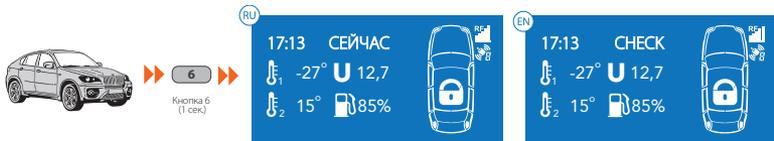
Для получения информации о температуре двигателя, салона, напряжения аккумулятора и уровня топлива (зависит от автомобиля) необходимо нажать и удержать в течение 1 сек. кн. 6. Для выхода из режима коротко нажмите кнопку F или выход произойдет автоматически через 10 сек.
