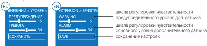
Вход и выход из строки регулировки чувствительности осуществляется коротким нажатием на кнопку 5. Для регулировки чувствительности используйте клавиши 4 (уменьшение чувствительности датчика) и 6 (увеличение чувствительности датчика). Диапазон регулируемых значений чувствительности составляет от 0 (минимальная чувствительность) до 50 (максимальная чувствительность).
