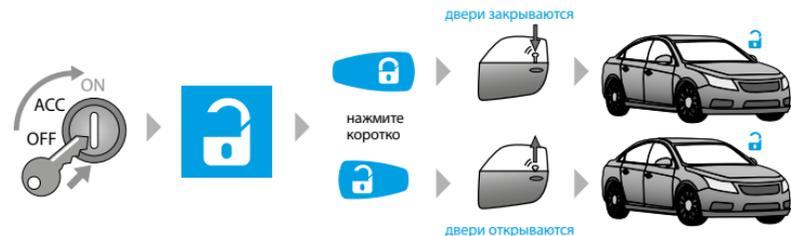
Предусмотрены режимы автоматического запираения дверей при начале движения или при включении зажигания. Отпираение дверей происходит при выключении зажигания сразу. В настройках предусмотрена возможность запрета отпираения дверей при выключении зажигания.
