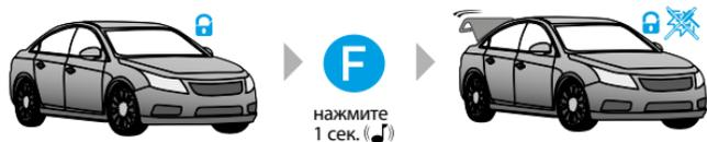
Если система находится под охраной, то одновременно с открытием замка багажника из контура охраны исключается зона багажника и отключается шок-сенсор и дополнительный датчик, все остальные зоны остаются под охраной.
